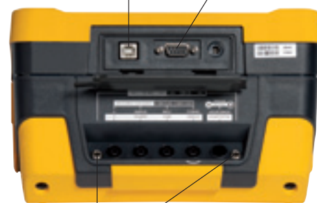
Gniazda do pomiarów rezystancji wzorcowej 10 MOhm
