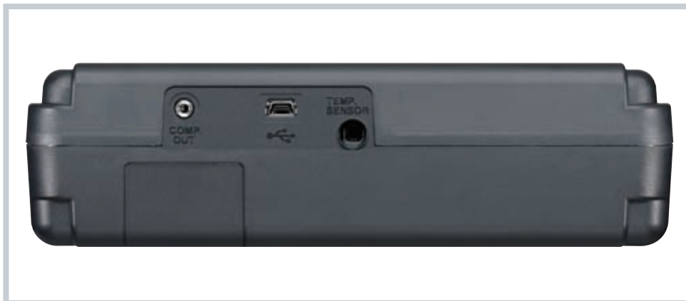
Fot. 2. Gniazda pamięci przenośnej USB, sondy temperaturowej i wyprowadzania sygnału komparatora
