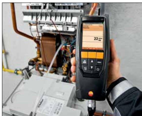
Wymagane akcesoria: Zestaw połączeniowy z przewodem elastycznym do osobnego pomiaru ciśnienia gazu nr katalogowy 0554 1203
