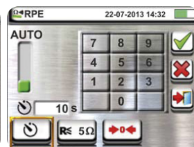
Wybór trybu pomiarowego AUTO lub TIMER
