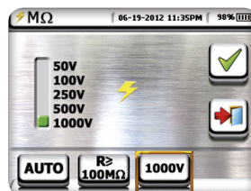
Wybór napięcia testowego oraz minimalnej wartości granicznej
