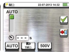
Wybór trybu pomiarowego AUTO lub TIMER
