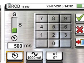
Ustawianie czasu opóźnienia RCD
