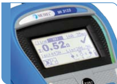
Duży wyświetlacz LCD z podświetleniem i wskaźnikiem DOBRY.ZŁY
