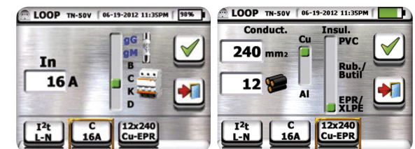
Ustawianie typu MCB/ bezpiecznika oraz prąd znamionowy
