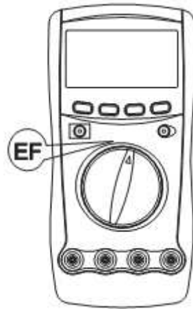
Rysunek 11. Wykrywanie obecności pola elektrycznego
