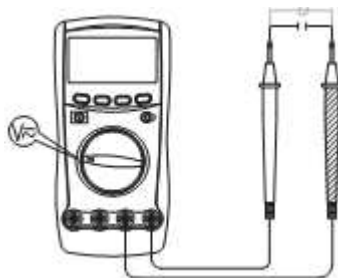
Rysunek 3. Pomiar napięcia stałego DC
