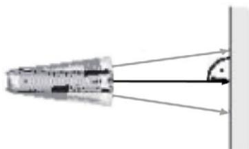
W niektórych przypadkach może zająć konieczność przeprowadzenia pomiaru ciągłego. W tym trybie, urządzenie pomiarowe może być przesuwane w pobliżu celu, przy czym wartość mierzona jest aktualizowana co ok. 0,5 sekundy. Minimalna i maksymalna wartość jest wyświetlana odpowiednio w wierszu pierwszym i drugim.
