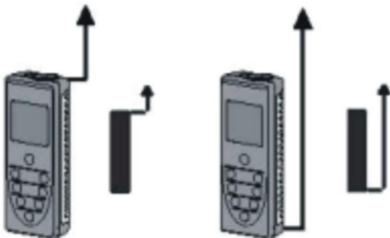
Setarea standard a nivelului de referinta se face din partea din spate a dispozitivului.
